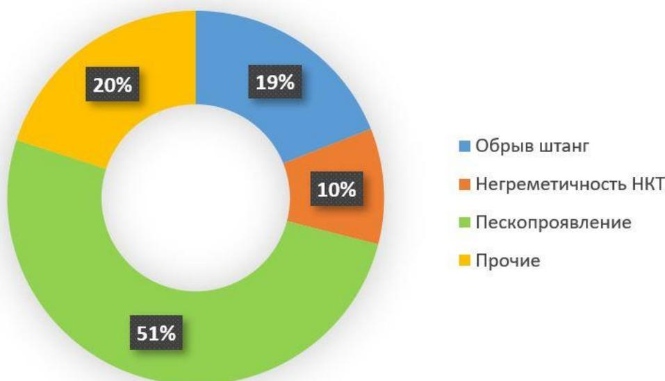
Рисунок 2 – Распределение причин отказов УШВН, связанных с пескопроявлением, на месторождении Северные Бузачи за период 2009–2013 гг. [2, 3]
