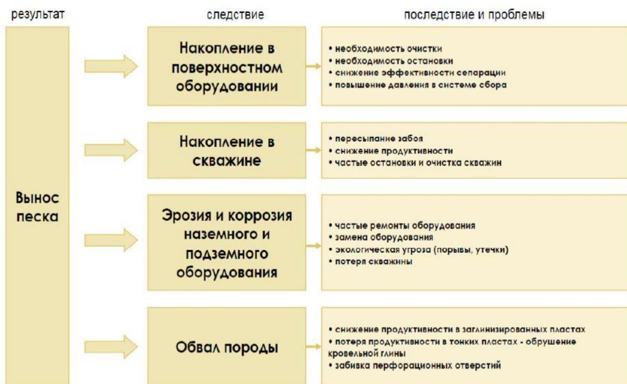
Рисунок 4 – Последствия пескопроявления [4]
